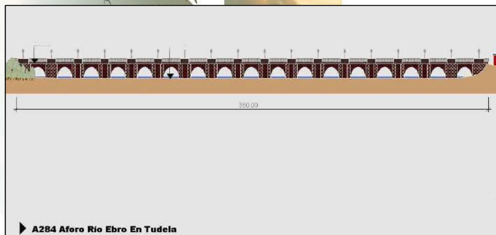
**Ilustración 12.** Esquema de medición de la sección de la estación de aforo de la CHE en el río Ebro en Tudela.
